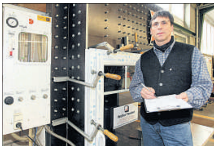
Am Prüfstand: Schreinermeister Stefan Schneider testet, ob die Fenster einem hohen Winddruck standhalten.
